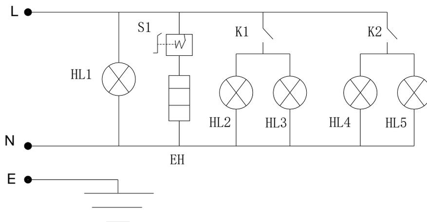
D1-Индикатор питания R-Трубка нагрева D2, D3-Светодиодный индикатор
